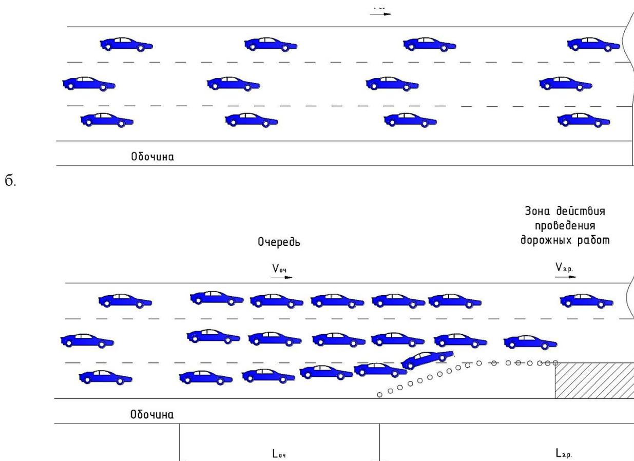
Рисунок 1. Схема движения потока автомобилей: а - при свободном движении; б - при перекрытии полосы движения
